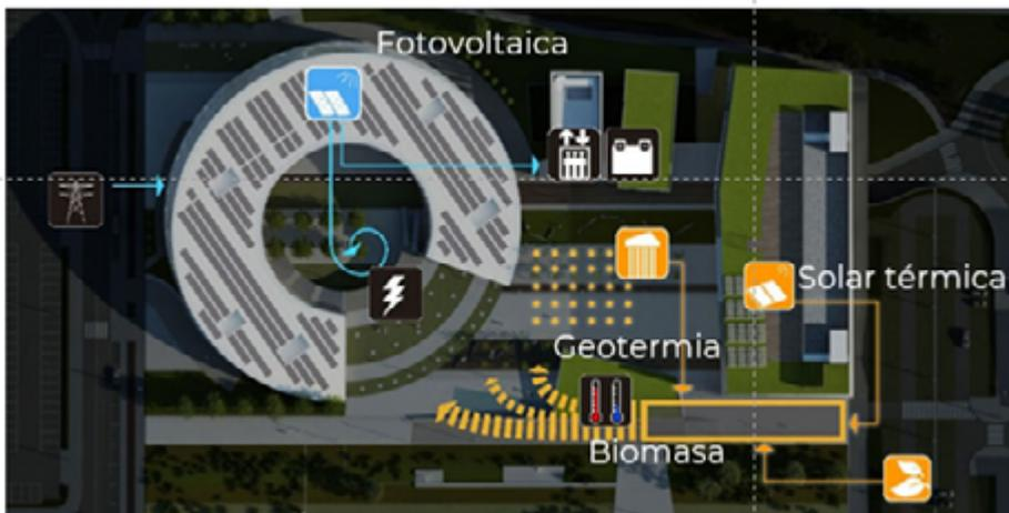
En azul origen y consumo de la energía eléctrica y en naranja origen de la energía térmica distribuida a través del District Heating-Cooling.
